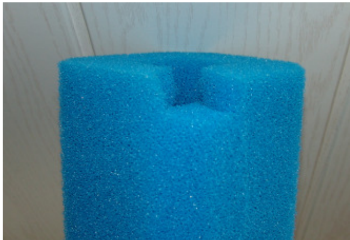
Ausgeschnittene Ecke für einen besseren Halt und Platzierung des Lufthebers
