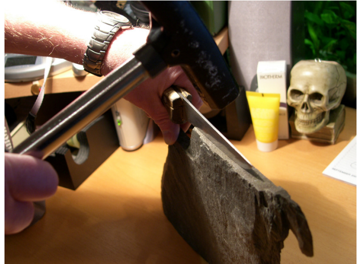
Dickere Schieferplatten können mit einem alten Messer oder eine Cutter-Klinge gespalten werden. Einfach in Schichtrichtung ansetzen und vorsichtig mit einem Hammer anklopfen. Der Schiefer spaltet dann relativ sauber, einzelne Splitter sind natürlich sauber zu entfernen. Foto: Bernd Poßbeckert
