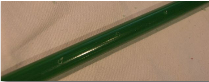
Alle Bohrungen müssen in einer Reihe mit gleichem Winkel gebohrt werden, um einen gleichmäßigen Wasserfluss zu gewährleisten.
