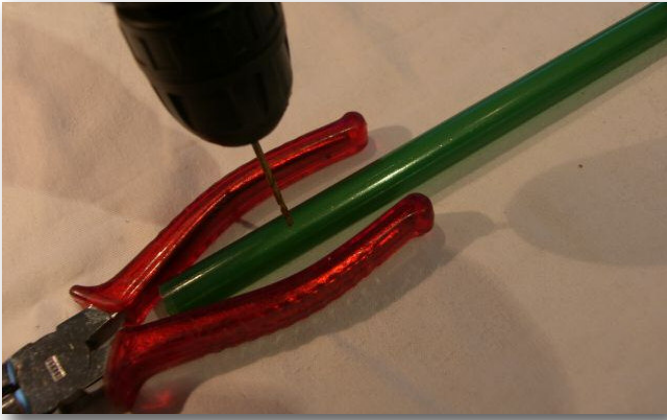
Für die Öffnungen im Ausströmerauslauf haben sich 3 mm-Bohrung gut bewährt.
