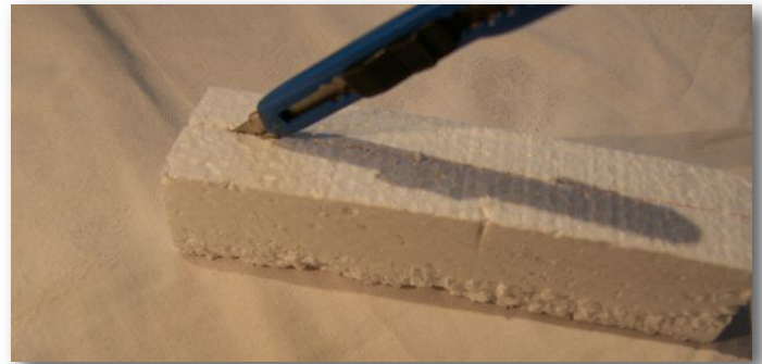
Der Zuschnitt von Styropor ist mit einem Cuttermesser problemlos möglich
