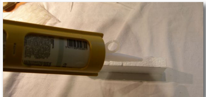
Mit Aquariensilikon werden die Schwimmkörper angeklebt.
